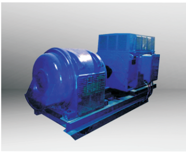
电机对拖试验平台
