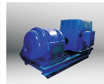
电机对拖试验平台
